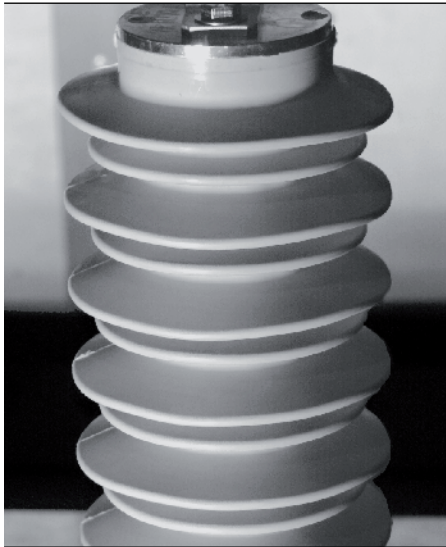
2 Carcasa de silicio del filtro de sobretensiones de tipo POLIM-H 33 durante la prueba con un caudal de aire de 100 m/s (360 km/h).
